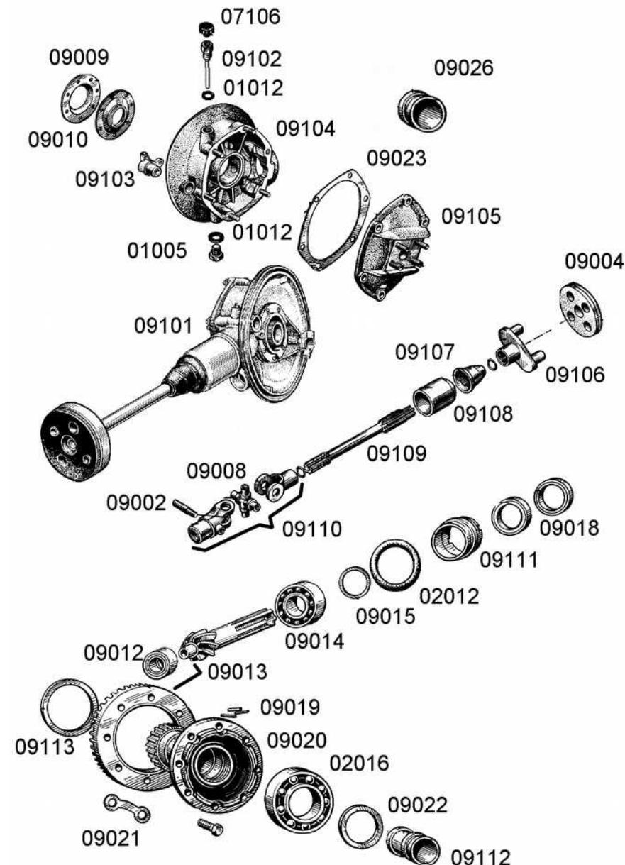
**Bild 10 Endantrieb mit Differential**
