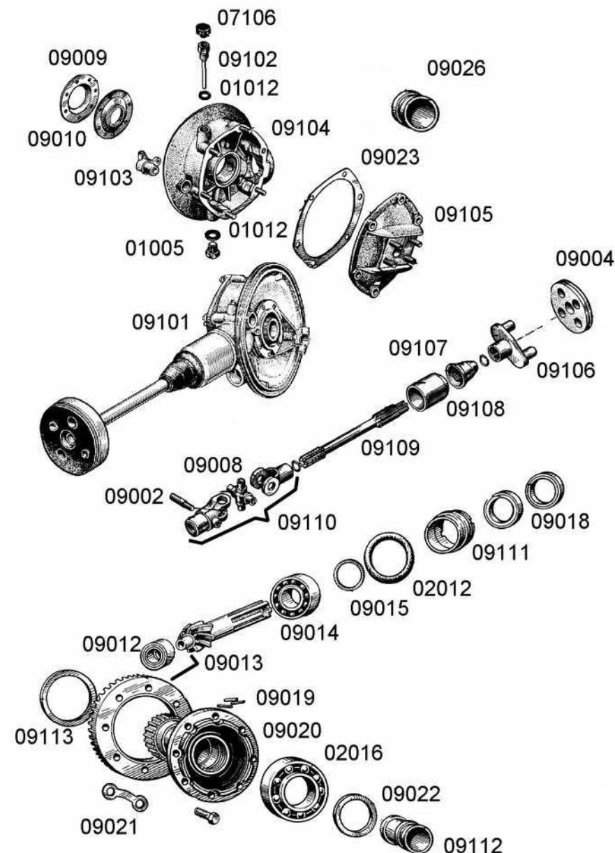
**Bild 10 Endantrieb mit Differential**
